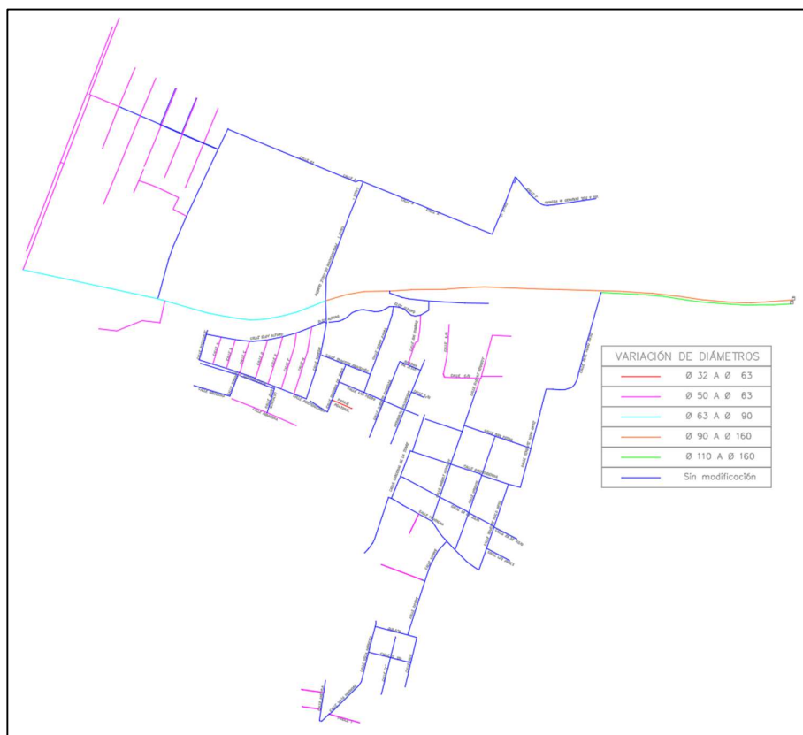
Ilustración 19: Identificación de diámetros que varían en relación a los existentes en la red Los Pinos
