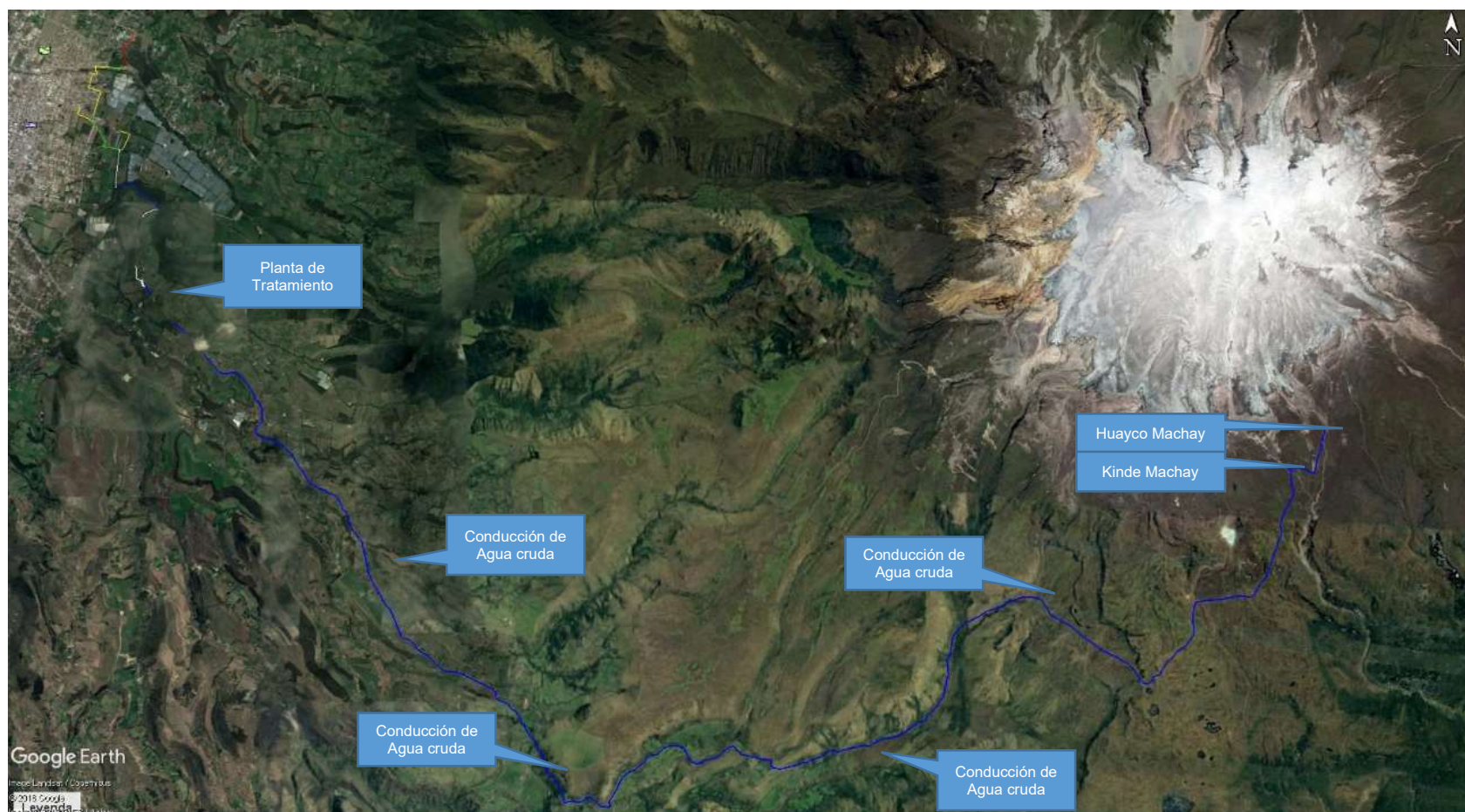
Ilustración 13: Esquema del proyecto de agua potable Huayco - Machay
