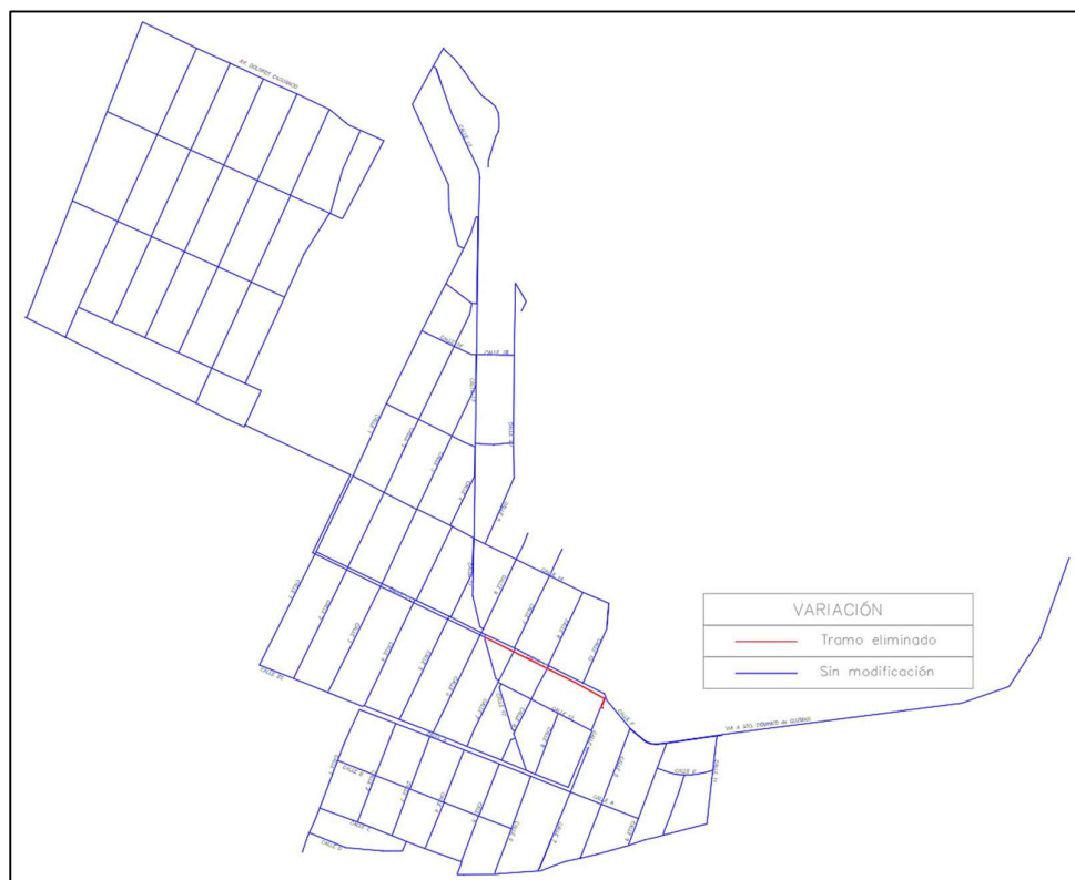
Ilustración 20: Identificación de tramo a discontinuar en la red El Quingo
