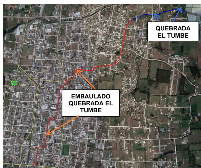
Ilustración 4: Embaulado Quebrada El Tumbe, Fuente: EMAPAAC EP
