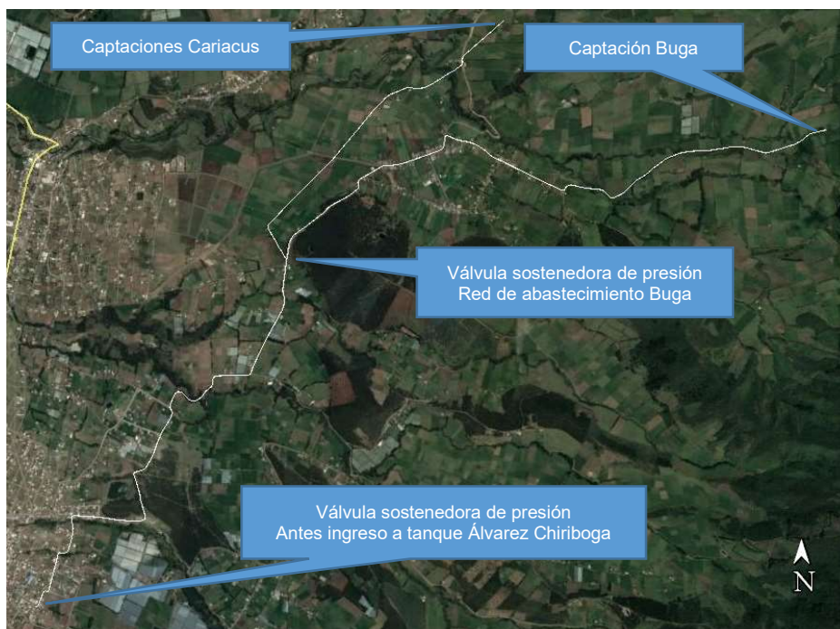
Ilustración 12: Esquema de red del sistema Cariacus – Buga / Optimización – 1
