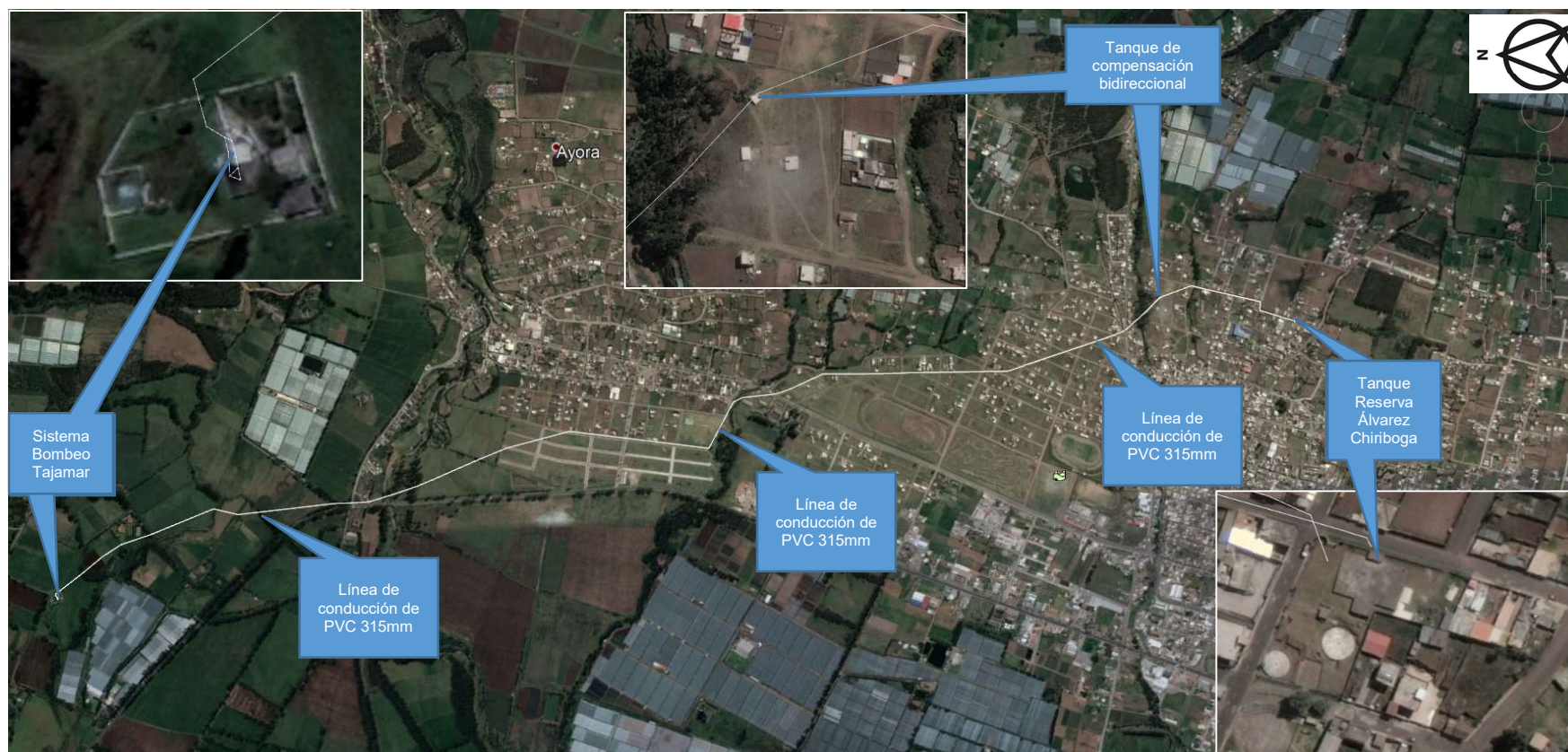
Ilustración 10: Ubicación del sistema de bombeo Tajamar con la variante de control de transitorios hidráulicos con tanque de compensación bidireccional.
