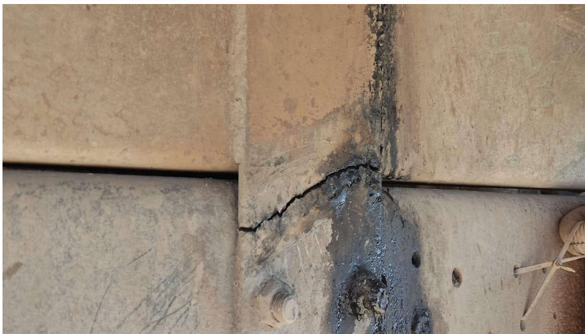
Fotografía 5. Daño estructural de las bases de sujeción de la caja compactadora con el chasis del vehículo recolector Volkswagen 01.
