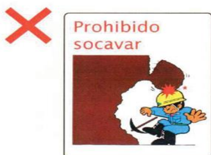
Ilustración 3.- Nunca se debe realizar la socavación.
