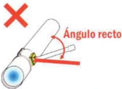
Ilustración 7.- Angulo de instalación del tubo de conexión domiciliaria.
