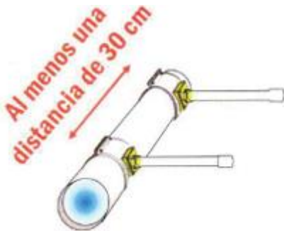
Ilustración 5.- Garantizar la distancia de ramificación.
