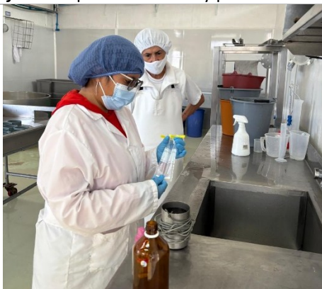
Fotografía 2. Monitoreo y verificación de parámetros de calidad de agua potable – Usuario Sector “Chimborazo”
